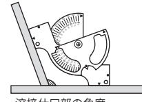
溶接仕口部の角度 (0°~180°:図は110°)
