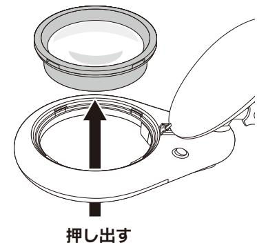
②2倍システムレンズを拡大鏡の枠に装着してください。
