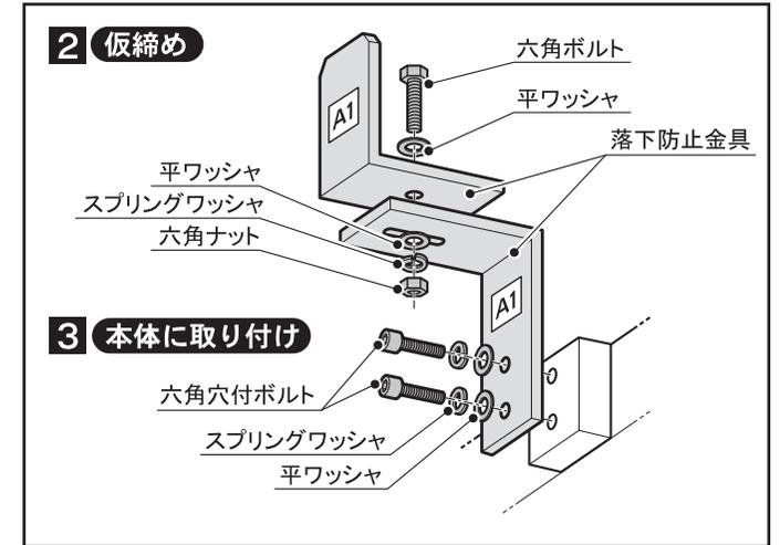
3 組み付けた落下防止金具のセットを架台本体に取り付けます。
