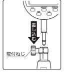
測定する寸法に合わせて、替えロッド・替えワッシャ・サブロッド (CDI-160Dのみ)を選択します。
