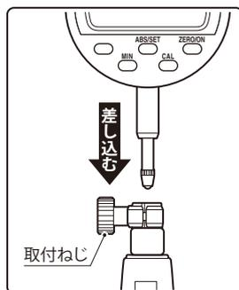
② 測定する寸法に合わせて、サブロッド (WCDI-160Dのみ)・換えロッド・ワッシャを選択します。換えロッド取付ねじを外し、サブロッド・換えロッド・ワッシャを本体に取り付け、換えロッド取付ねじで固定してください。
